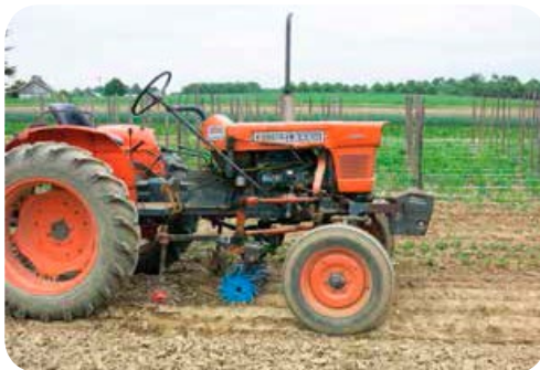
شکل ۹: کولتیواتور عنکبوتی Bezzeridi که سله (پوسته سخت زمین) را شکسته و خاک زیادی پرتاب نمی کند.
